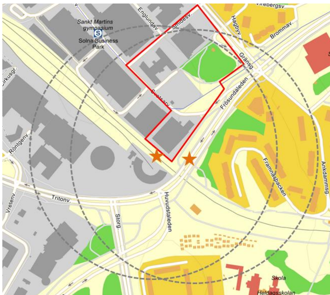
Figur B.1. Översiktspå bild över aktuellt planområde och dess omgivning. Mörkgrå markering visar ungefärligt maximalt påverkansområde (ca 300 meter) för olycka på Frösundaleden och Mälärbanan. Röd markering visar ungefärlig avgränsning av aktuellt planområde. Orangea stjärnor visar antagna placeringar av respektive olycksplats på studerade riskkällor.
