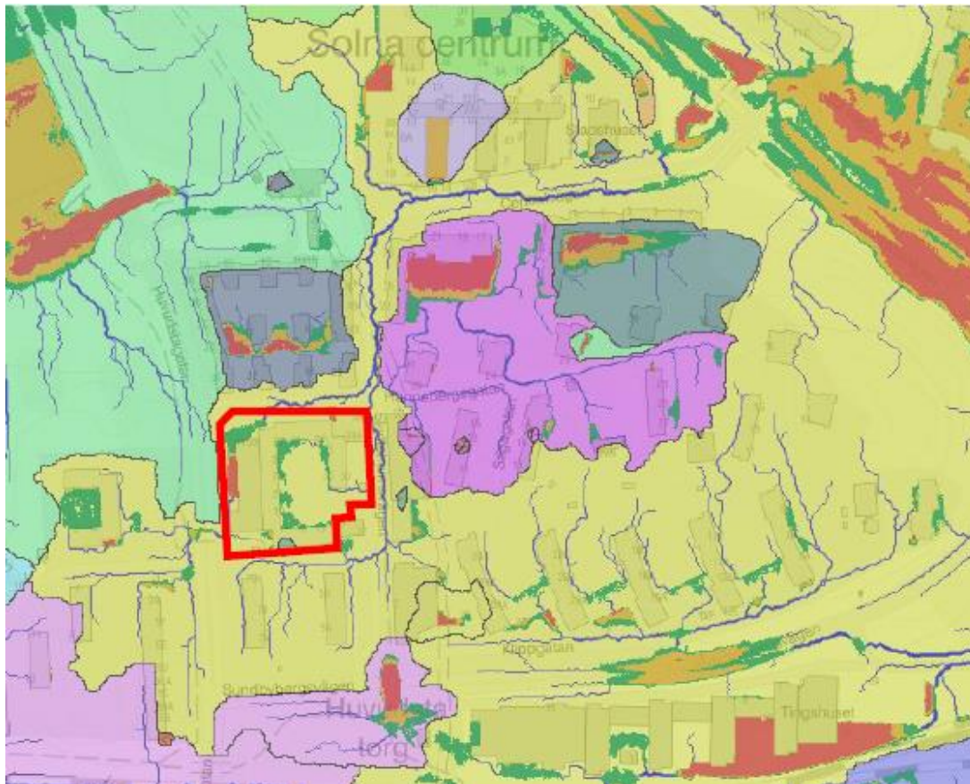
Modellerade avrinningsområden, lågpunkter och avrinningsstråk vid en nederbörd på 50 mm i befintlig situation i SCALGO Live. Fastigheten Turkosen 1 ungefärligt markerat i rött.
