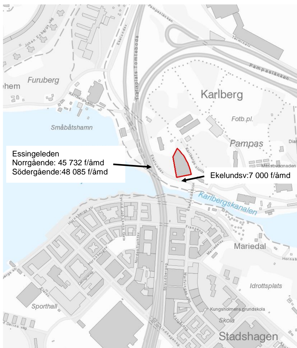
Översiktsskarta med trafikflöden som fordon per årsmedeldygn (f/åmd). Placering av nytt huvudkontor för JM visas med rödmarkerad polygon.
