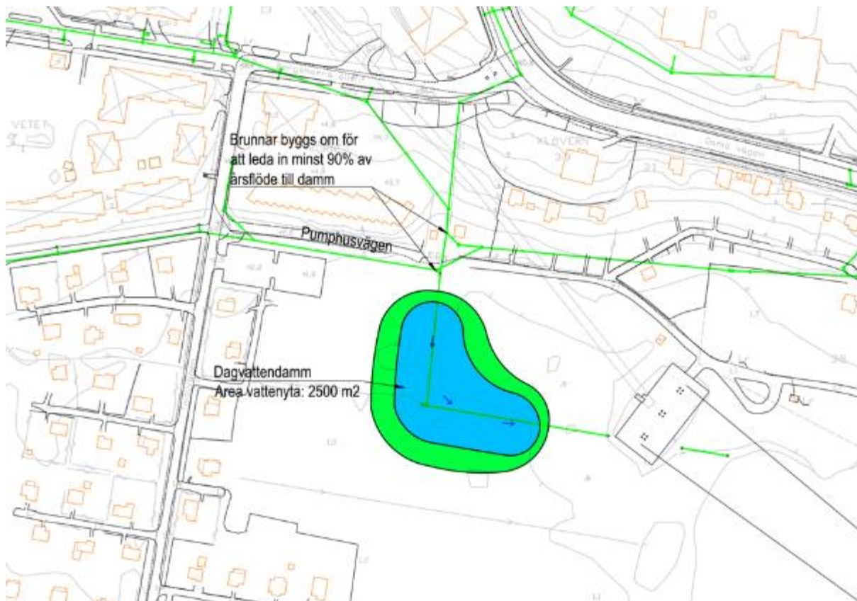
Figur 14. Dagvattendamm vid Pumphusvägen.
