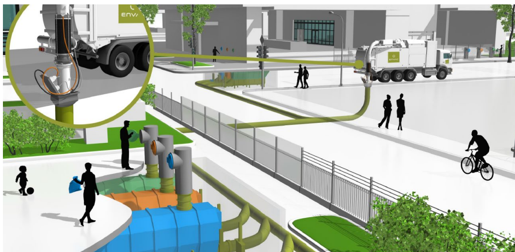
Figur 6. Illustration över hur en mobil sopsug fungerar. Hämtad från mail från Envac 2023.
