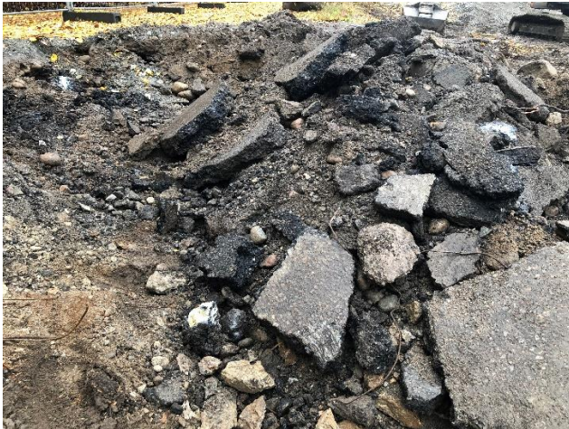
Figur 4. Exempel på asfaltsutfyllnaden. De största asfaltsbitarna på bilden är ca 0,4 x 0,4 m stora. (2022-10-18)
