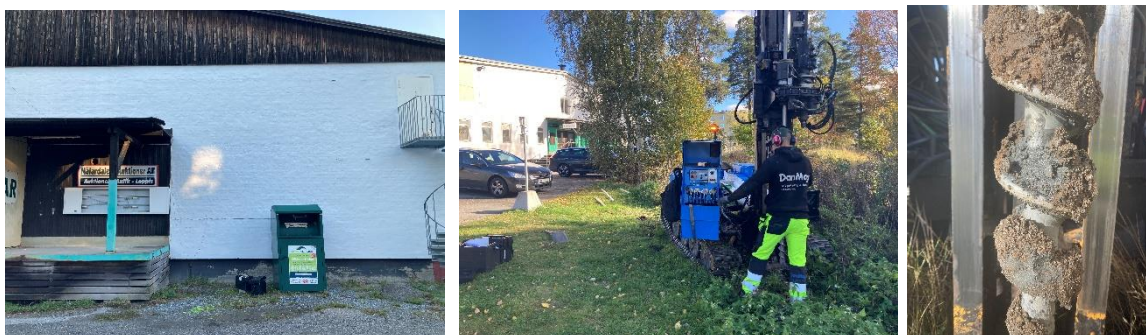
Figur 12. (Vänster) Placering av 22VM01 intill försvarets f.d. förråd. Sydvästra gaveln. (Mitten) Placering av 22VM04. (Höger) Skruvborr från 22VM07 där petroleumluk noterades och halter aromater över MKM uppmättes. (2022-10-10, 2022-10-11, 2022-10-12)
