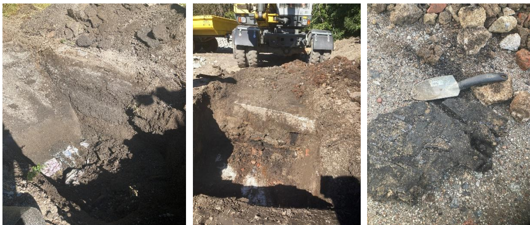
Figur 17. Bilder från tippområde 2, vid grusyta. (Vänster) Provgrop 22VM11. Ö&B-plastpåsar från 0,7 m djup. (Mitten) Provgrop 22VM13. Betongbalk, tegel och asfaltsbitar i grop. (Höger) Svartglansigt material i 22VM14 med uppmätta halter alifater och aromater >C16-C35 över MKM. (2022-08-25, 2022-08-29)
