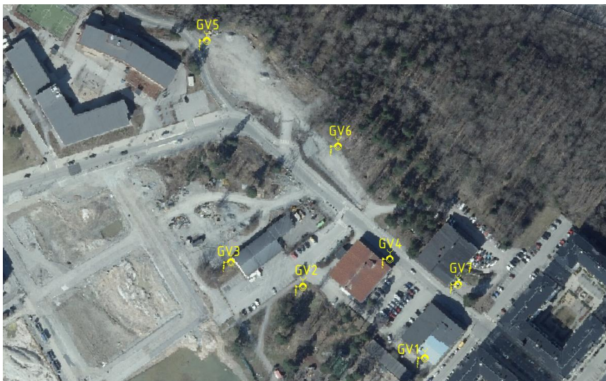
Figur 10. Karta över installerade grundvattenrör. Vid provtagning gav dock inte GV4 och GV5 något vatten, således är det enbart GV1-GV3 samt GV6-GV7 som har provtagits.
