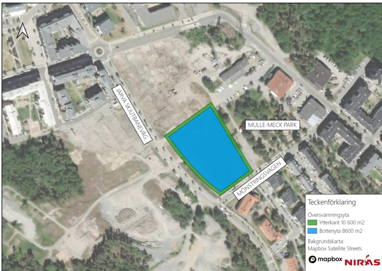
Figur 3 Illustration av framtaget utformningsförslag av översvämningsytan, ytterkanten följer ungefär samma placering som dagens urschaktade yta.
