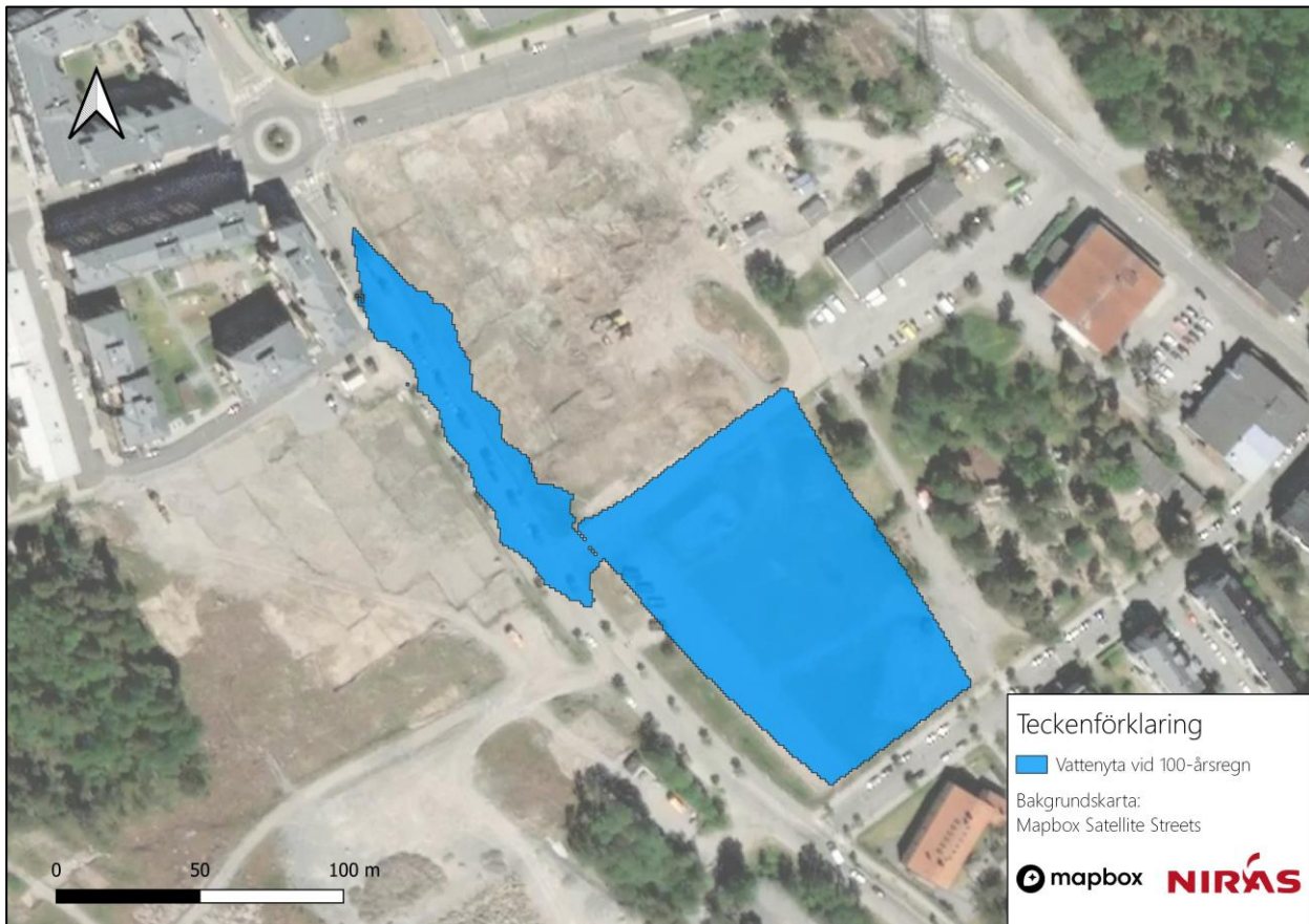
Figur 4 Utbredning av vatten vid ett 100-årsregn modellerat i Scalgo Live tillsammans med höjder från översvämningsytan samt projekterade höjder i Järva Skjutbaneväg.
