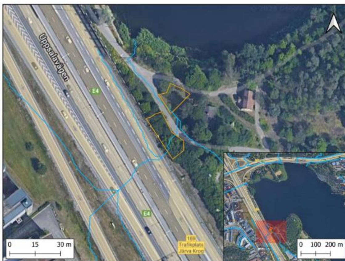
Figur 15. Möjliga områden för åtgärd vid E4, i samband med utlopp för dagvattenledningar.
