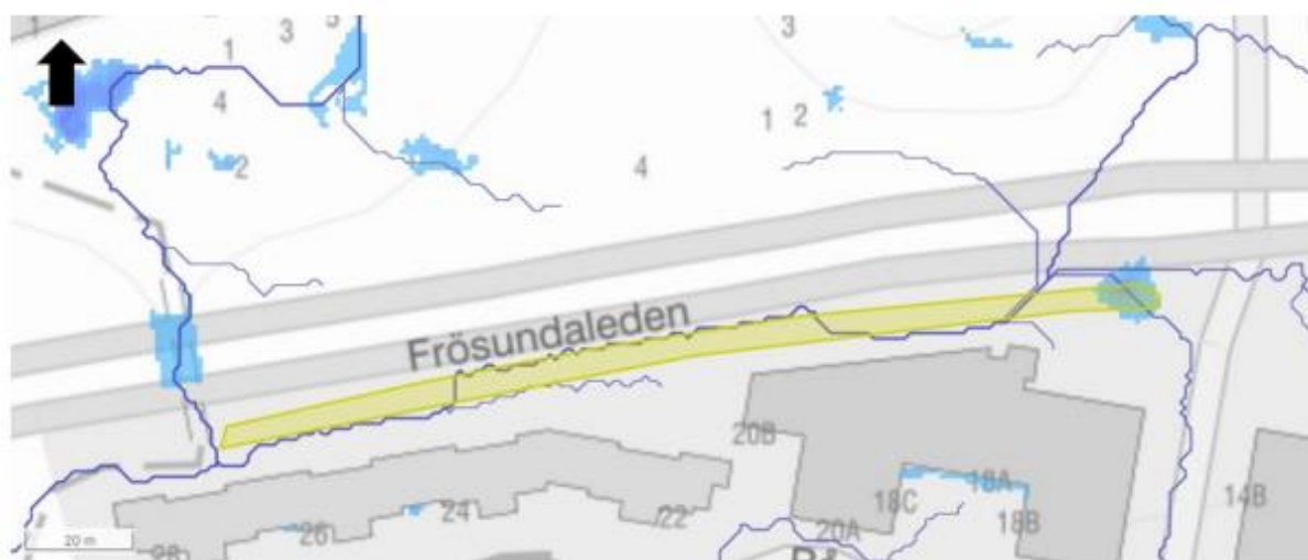
Figur 16. Område för dagvattenlösning, rinnvägar och ansamling av vatten vid 20 mm regn vid Frösundaleden. Källa: Ensucon AB.
