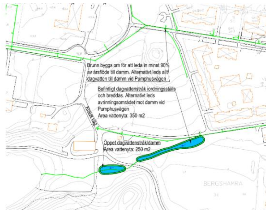
Figur 31. Damm/Dike vid Kraus väg.
