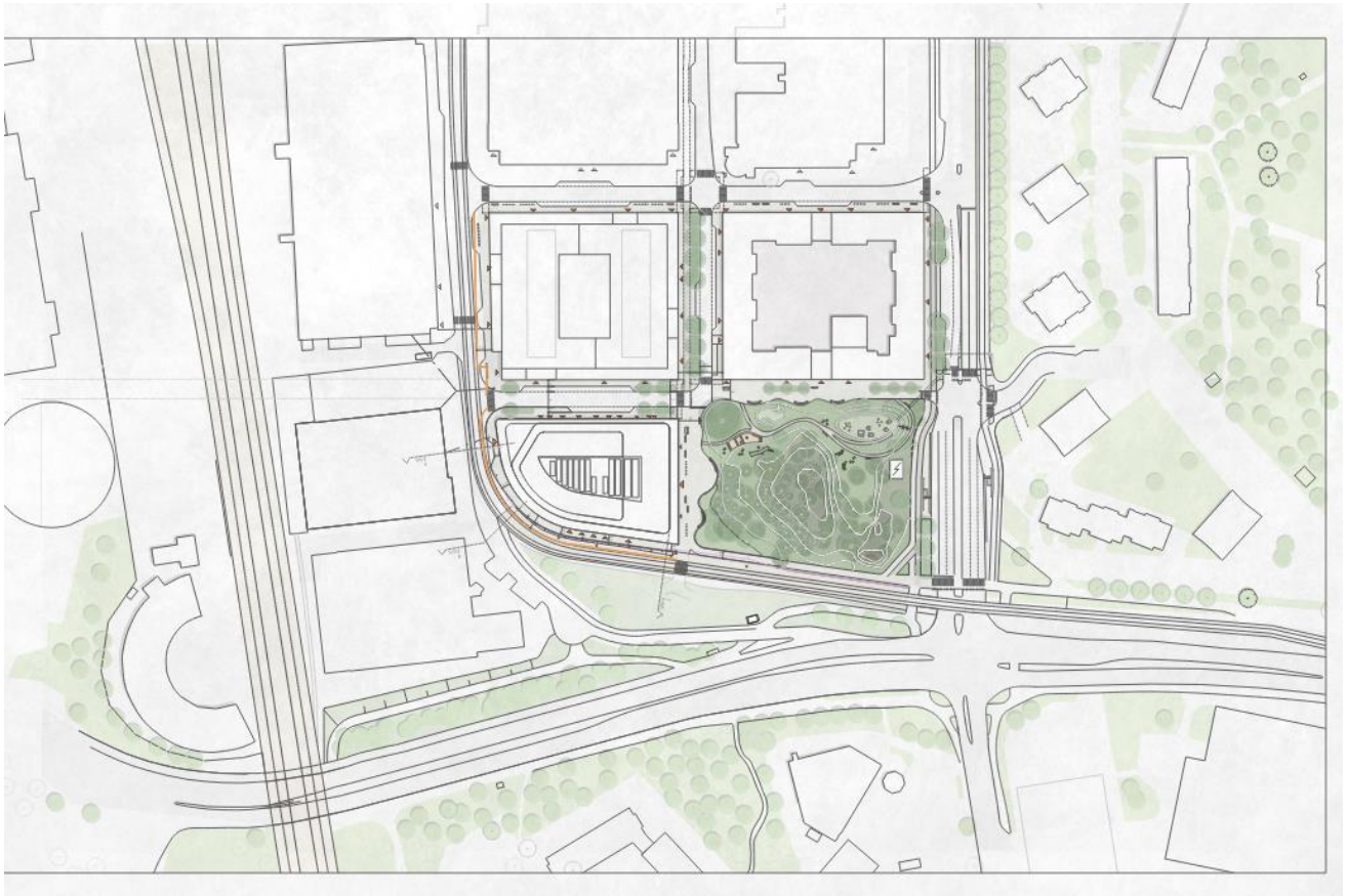
Figur 1 Situationsplan med en markerad 7-meterslinje från närmaste spår.
