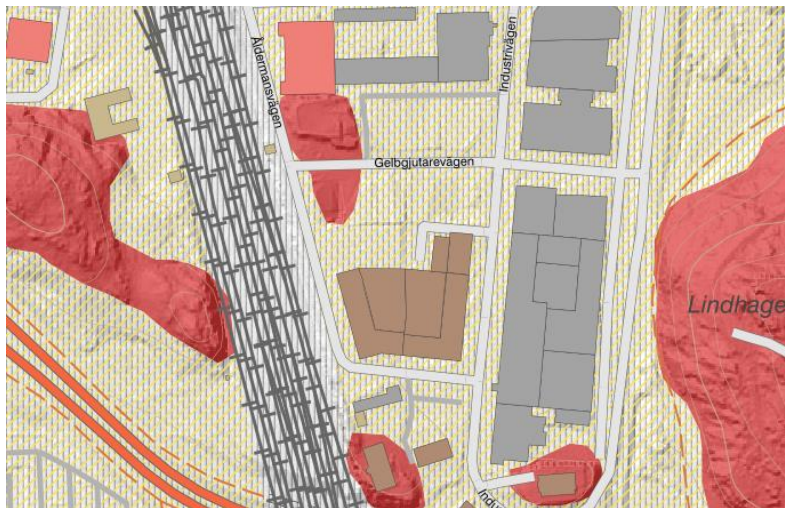
Figur 3. SGU:s jordartskarta. Rött=berg, rastretat gult= fyllning på postglacial lera, rastretat grått på vitt=fyllning.
