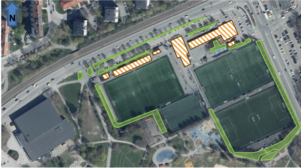
Figur 8. Befintlig markanvändning, grönytor markerade med grönt, taktytor markerade med orange skraffering. Övrig markanvändning är konstgräsplaner och hårdgjorda ytor.
