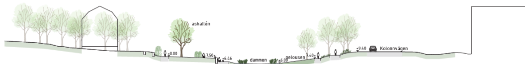
Figur 10. Sektion genom skyfallsmagasin vid Lilla Frösunda (Landskapslaget 2021)
