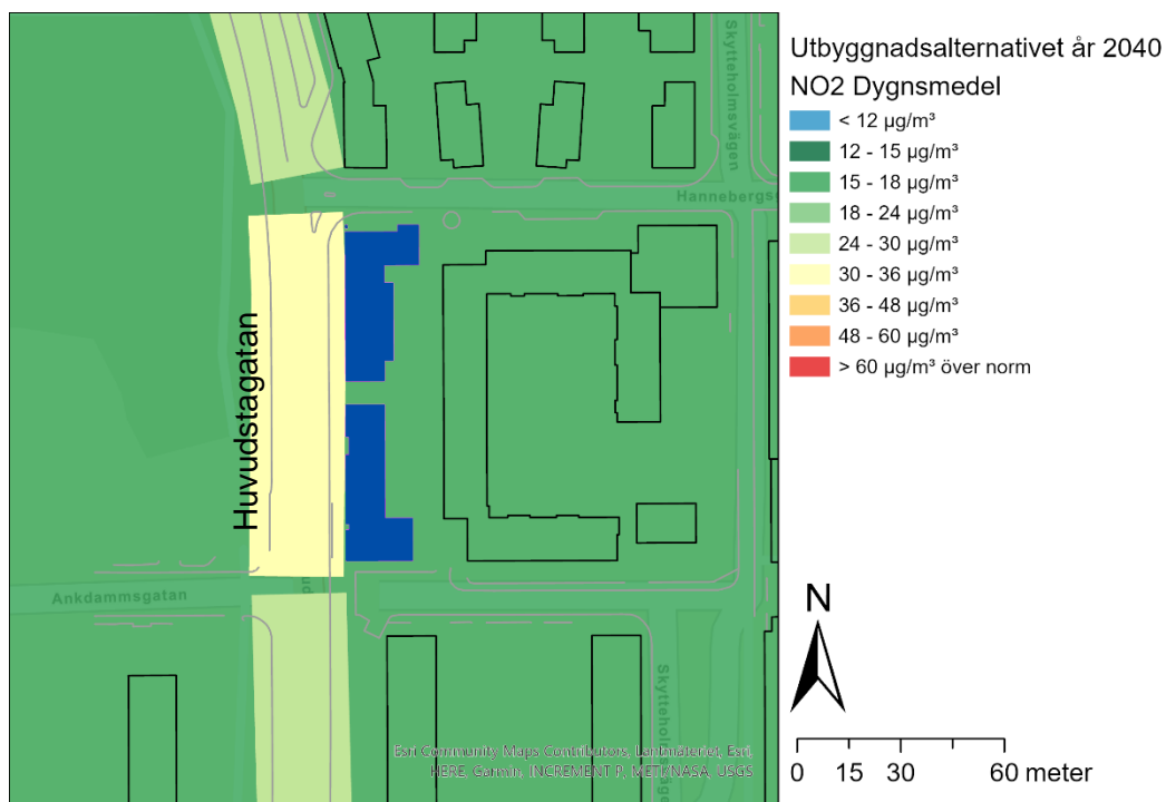
Figur 16. Beräknad dygnsmedelhalt av kvävedioxid, NO 2 (µg/m 3 ), under det 36:e värsta dygnet för utbyggnadsalternativet år 2040. Halterna gäller 2 m ovan mark för ett meteorologiskt normalår. Normvärdet som ska klaras är 60 µg/m 3 . Planerade byggnader visas som blå polygoner.
