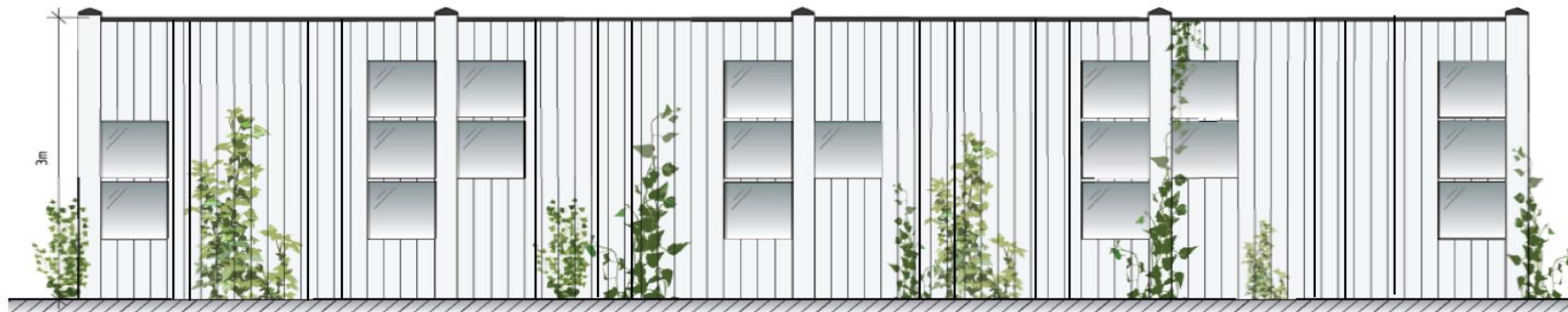
Bullerskärm sida mot skolgården med klättrväxter. Plank med olika bredd och djup för relief och skuggverkan
