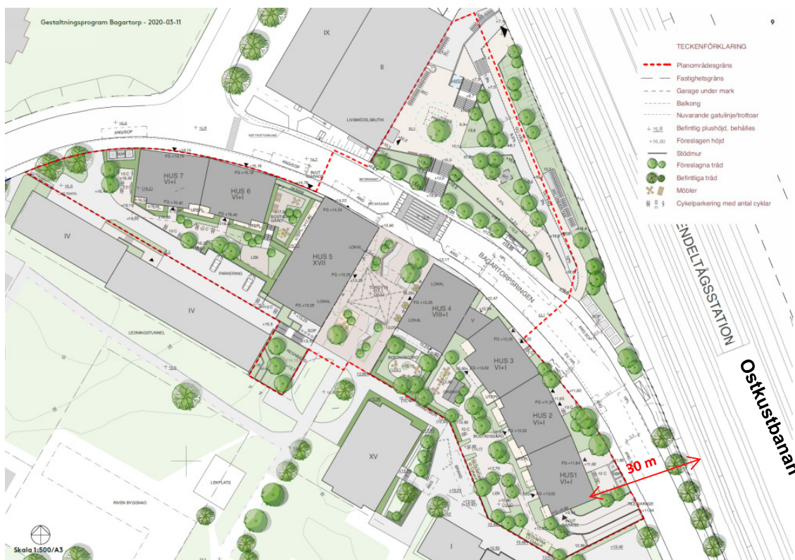
Figur B.9. Illustrationsplan för ny bebyggelse inom området Bagartorp, daterad 2020-03-11. Avståndsmätningen utgår från närmaste befintliga spår.
