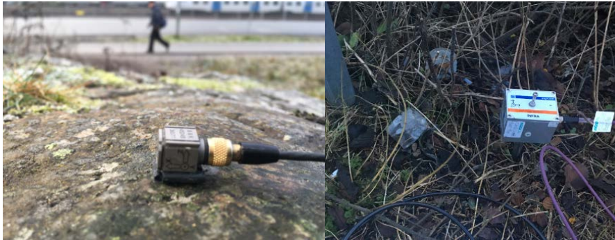
Figur 4: [Vänster]: Accelerometer på berg i mät punkt 1. [Höger]: Geofon på spett i lermark i mät punkt 2.
