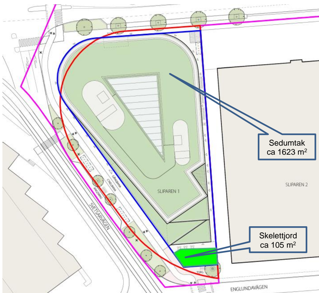
Figur 14. Tillgänglig yta för dagvattenhantering är schematiskt utritad i figuren. Blå polygon redovisar nya fastighetsgränsen efter nybyggnation och röd polygon befintlig fastighetsgräns.
