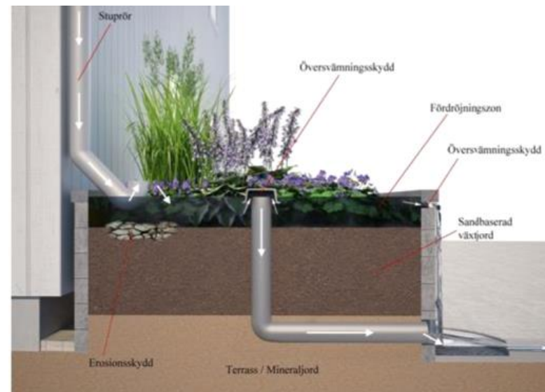
Figur 21: Utformning av växtbädd som anslutas direkt till stuprör. Källa: WRS AB, 2017 rev. 2019.
