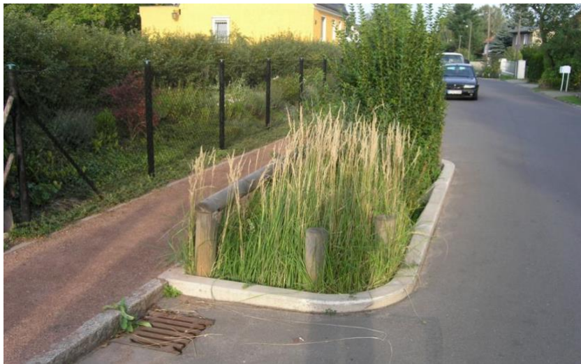
Figur 22: Exempel på nedsänkta växtbäddar vid vägyta. Källa: WRS AB, 2017 rev. 2019.
