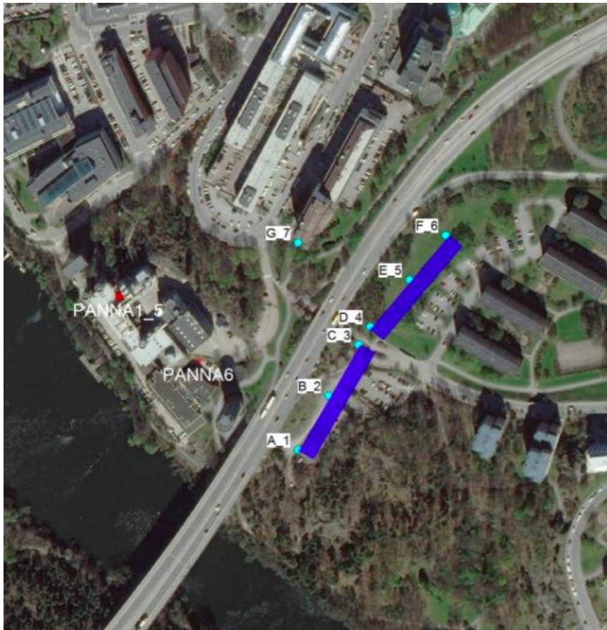
Figur 47. Receptorpunkter A-F som används för spridningsberäkningarna (källa: Sweco, 2017).
