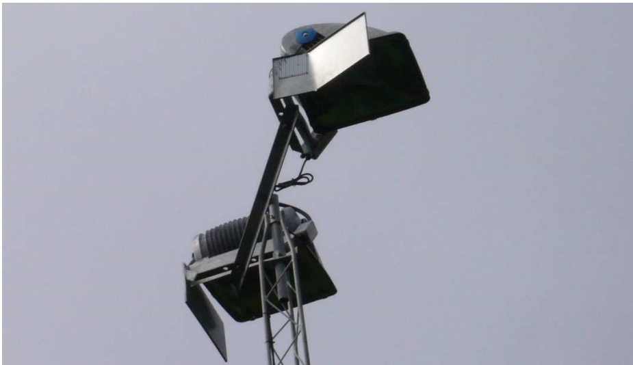
Bild 9 Närbild på specialtillverkad mekanisk avskärmning.
