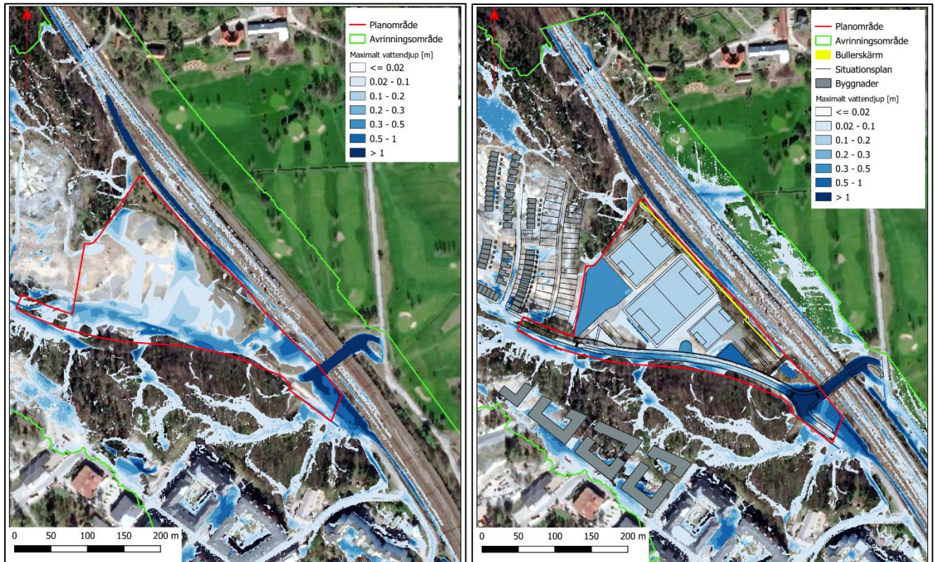
Figur 16 Skyfallskarteringar för ett 100 års regn med klimatafaktor 1,25 i dagens situation (till vänster) och efter ombyggnation med föreslagna åtgärder (till höger). Båda bilderna visar scenariot utan avdrag för ledningsnätet.
