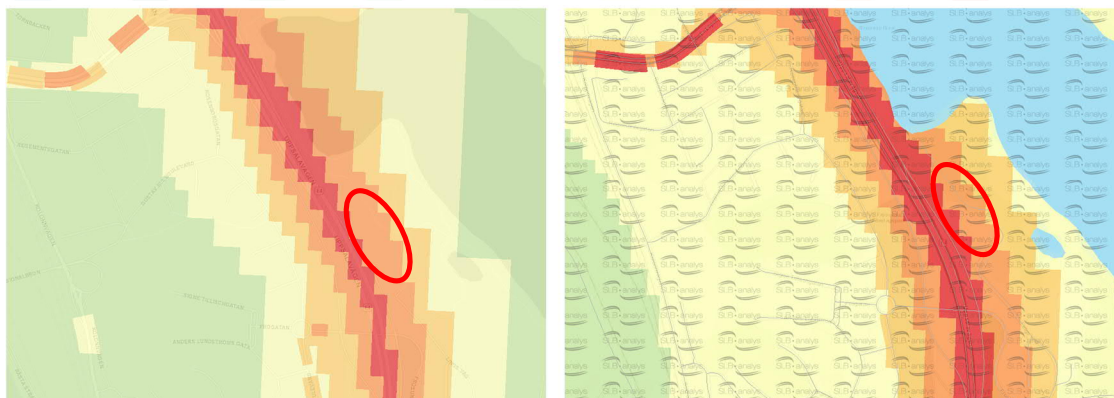
Figur 3 Beräknade halter av PM10 som 90-percentil dygn år 2020 (till vänster) och 2015 (till höger). År 2020 hamnar halterna i intervallet 30 – <50 µg/m 3 och tidigare beräkning för 2015 i intervallet 30 – ≥50 µg/m 3 .
