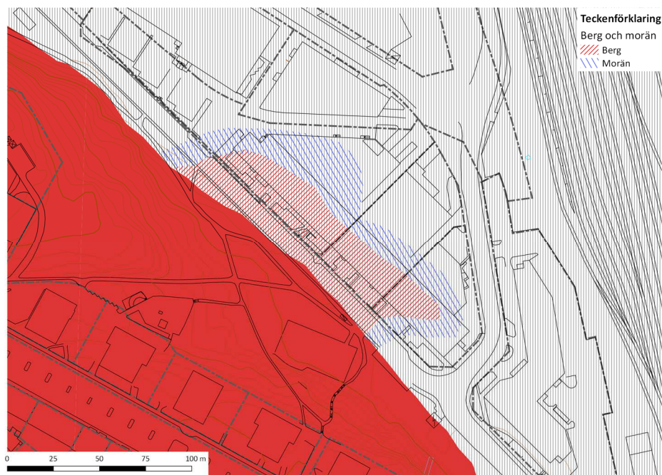
Figur 6. Tolkade berg och morän under byggnader inom Farao 15 till 17. (Underlag från (SGU wms, 2017)).
