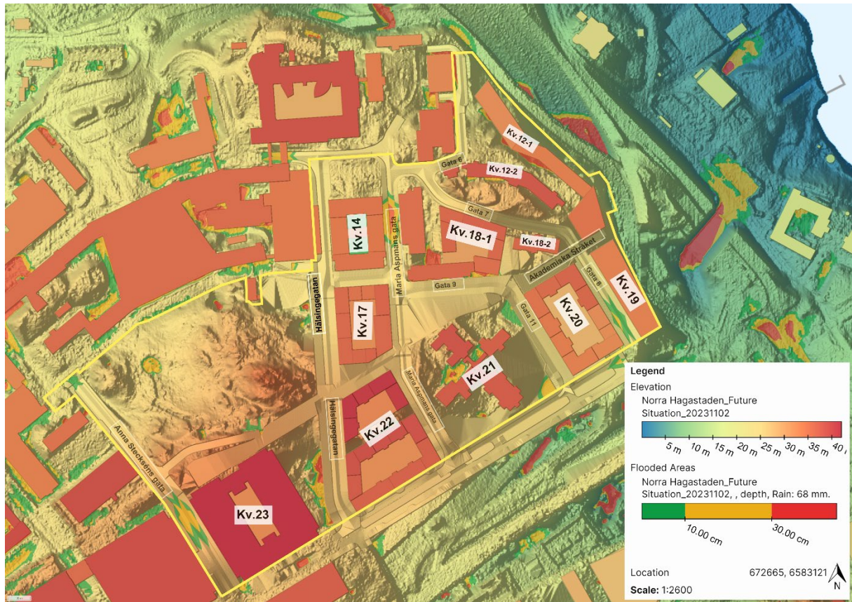
Figur 6. Planerad utformnings vattendjupet karta för skyfallsanalys vid 100 års regn med varaktighet 1 timme i utredningsområdet. Instängda områden där mer än 10 cm vatten riskerar att bli stående vid ett skyfall. Grön färg indikerar vattendjup på 0–10 cm, gult 10–30 cm och rött mer än 30 cm stående vatten (SCALGO Live, 2023).
