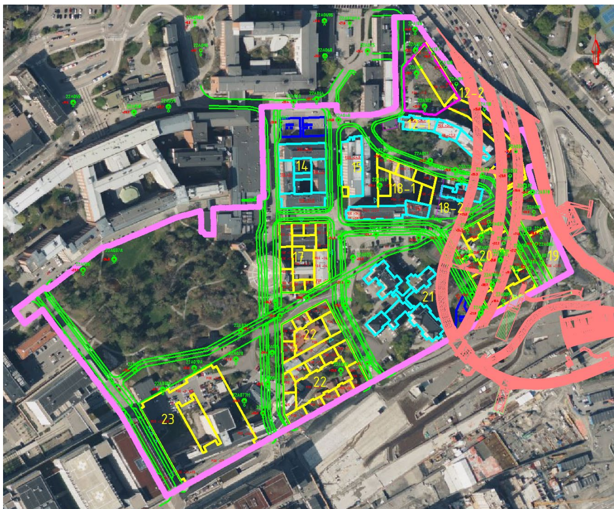
Figur 17. Översikt sektionsmarkeringar A-A till och med D-D över de fyra befintliga underliggande vägtunnlarna markerade med röd färg i den östra delen av området.
