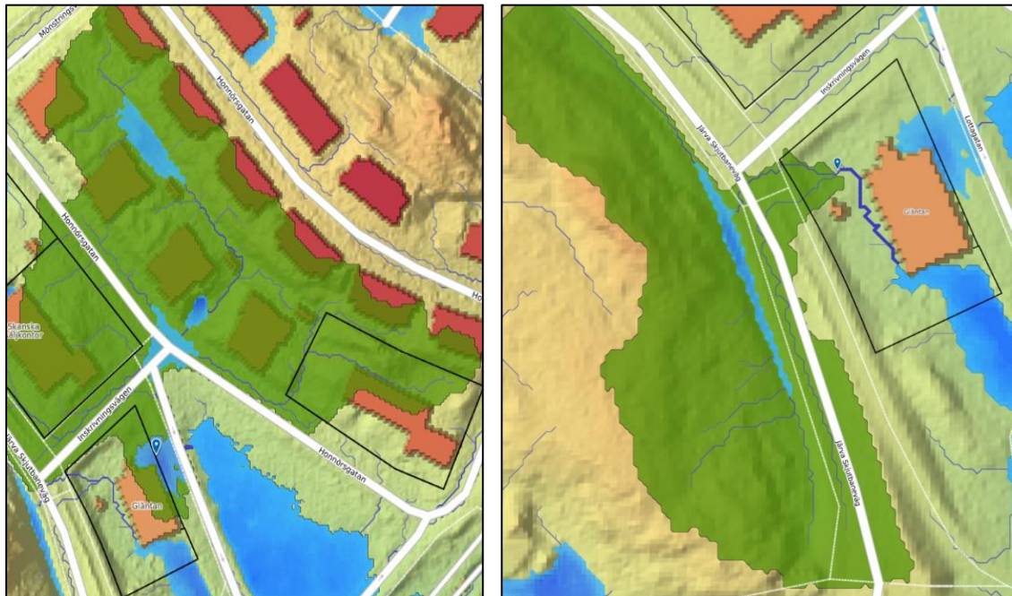
Figur 17 Avrinning från flerbostadshuset i norr samt från skogen i väst till fastigheten Inskrivningen 1 vid ett uppskattat skyfall visas i grönt.
