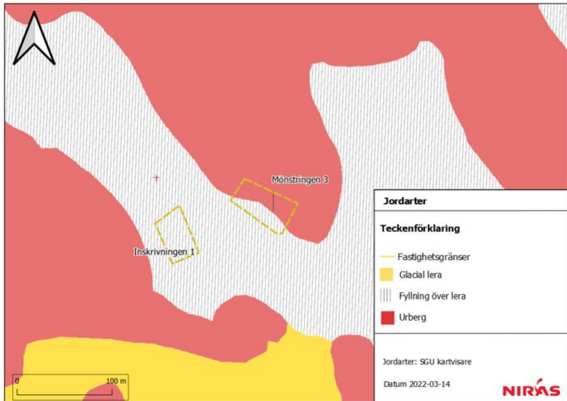
Figur 6 Marken vid fastigheterna består av fyllnadsmaterial med underliggande lager av lera.
