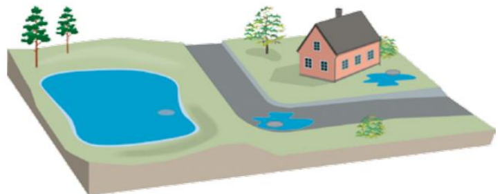
Figur 17. Principen för kartering av lågpunkter. Ingen hänsyn tas till markavrinning och ledningsnät. Bildkälla: MSB.
