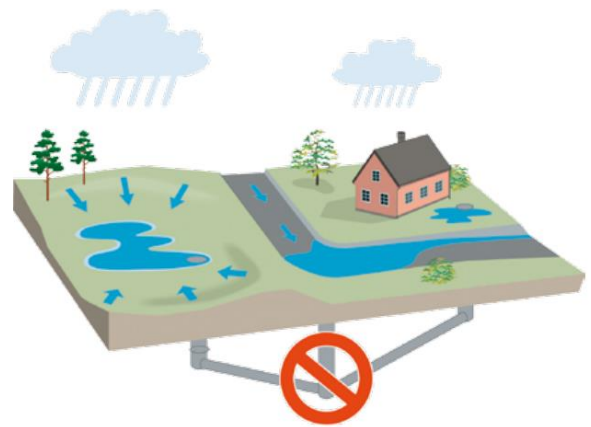
Figur 18. Vattnets väg och volym beräknas med hänsyn till studerat regn. Ledningsnätet beskrivs inte men regn över hårdgjorda ytor justeras med hänsyn till ledningsnätets bedömda kapacitet genom ett schablonmässigt avdrag. Bildkälla: MSB.
