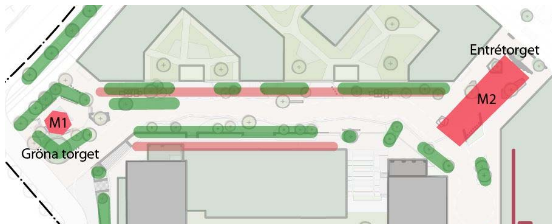
Figur 20. Föreslagen placering av ytliga magasin M1 och M2 vid Entrétorget och Gröna torget. Dessa kan fördröja dagvatten ytligt, men kan också fördröja vattnet i underliggande krossmagasin. Föreslagen placering av rörmagasin är markerade med rosa tjocka sträck.
