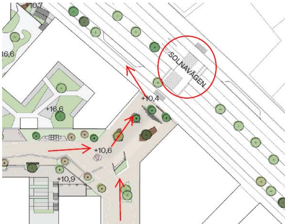
Figur 12. Detalj över upphöjd övergångspassage i Solnavägen, markerad med röd cirkel. Skyfallsväg från området redovisas med röda pilar.
