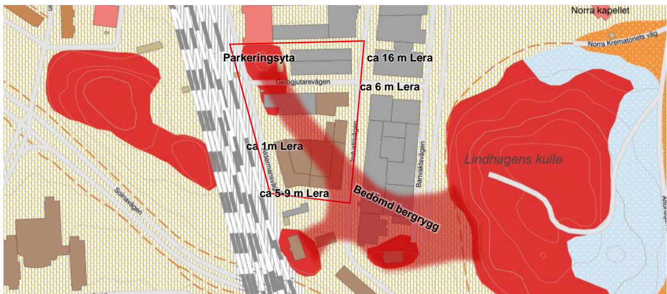
Figur 5. I geologiska kartbladet, SGU har bedömd höjdrygg tolkats in i sydöstlig-nordvästlig riktning (ungefärlig utbredning representeras av genomskinlig röd yta) samt har lermäktighet utifrån utförda undersökningar lagts in. Röd färg motsvarar berg, blå färg sandig morän, orange färg motsvarar postglacial sand, och grå/gul skrafferad vit färg motsvarar fyllning ovan lera.
