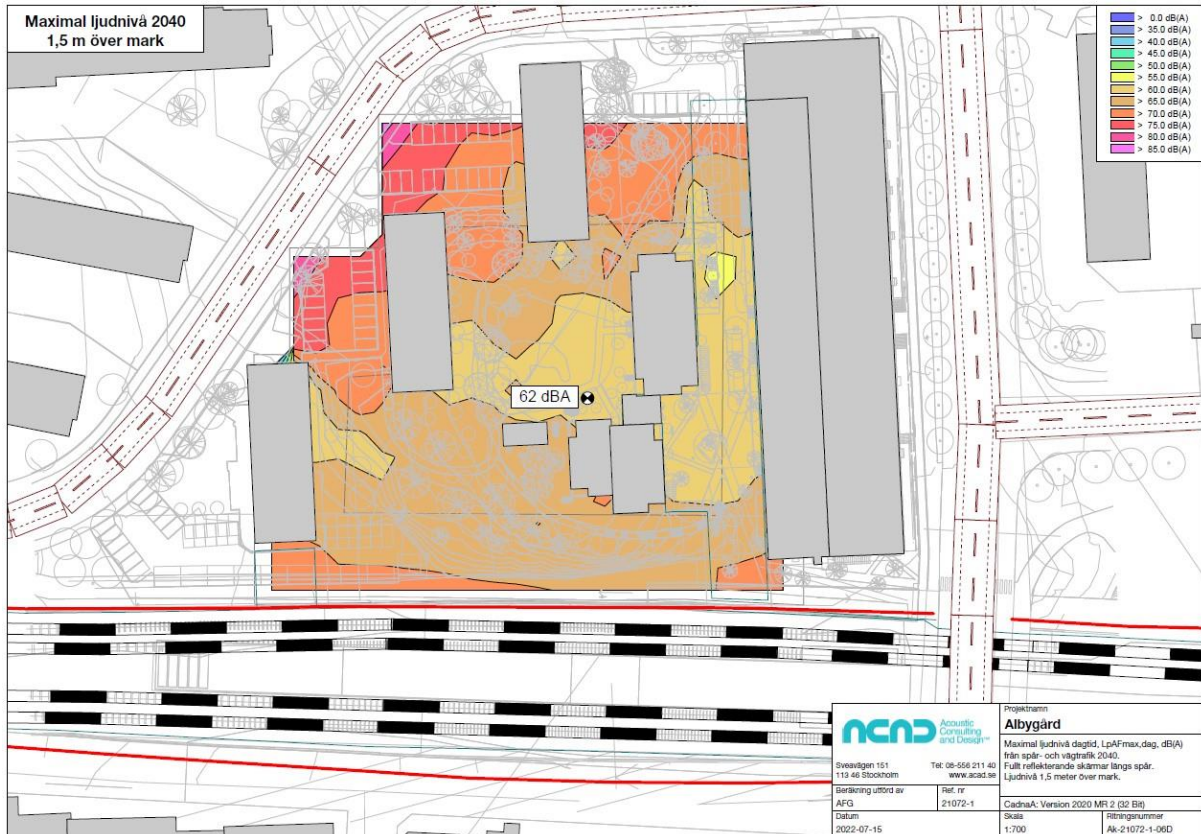
Figur 27. Maximal ljudnivå nattetid, LPAeq, dB(A) från väg och spårtrafik för trafik 2040. Fullt reflekterande skärmar längs spår.
