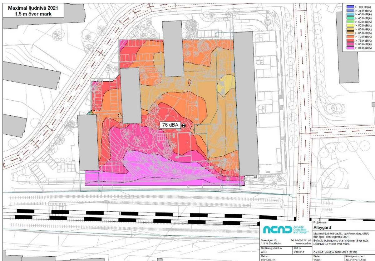
Figur 29. Maximal ljudnivå dagtid, L_{pAFmax,dag} , dB(A) från spår- och vägtrafik 2021. Befintlig bebyggelse utan skärmar längs spår.
