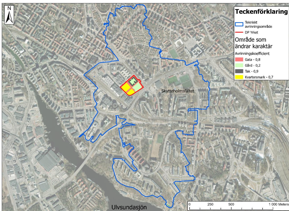
Figur 7. Framtida tekniskt avrinningsområde för Huvudsta samt framtida markanvändning. Avrinningskoefficienterna är ansatta utifrån P110 kap 4.4.1.4 samt 4.4.1.5 där kvartersmark satts utifrån slutet byggnadssätt, ingen vegetation. Källa ortofoto: Scalgo.
