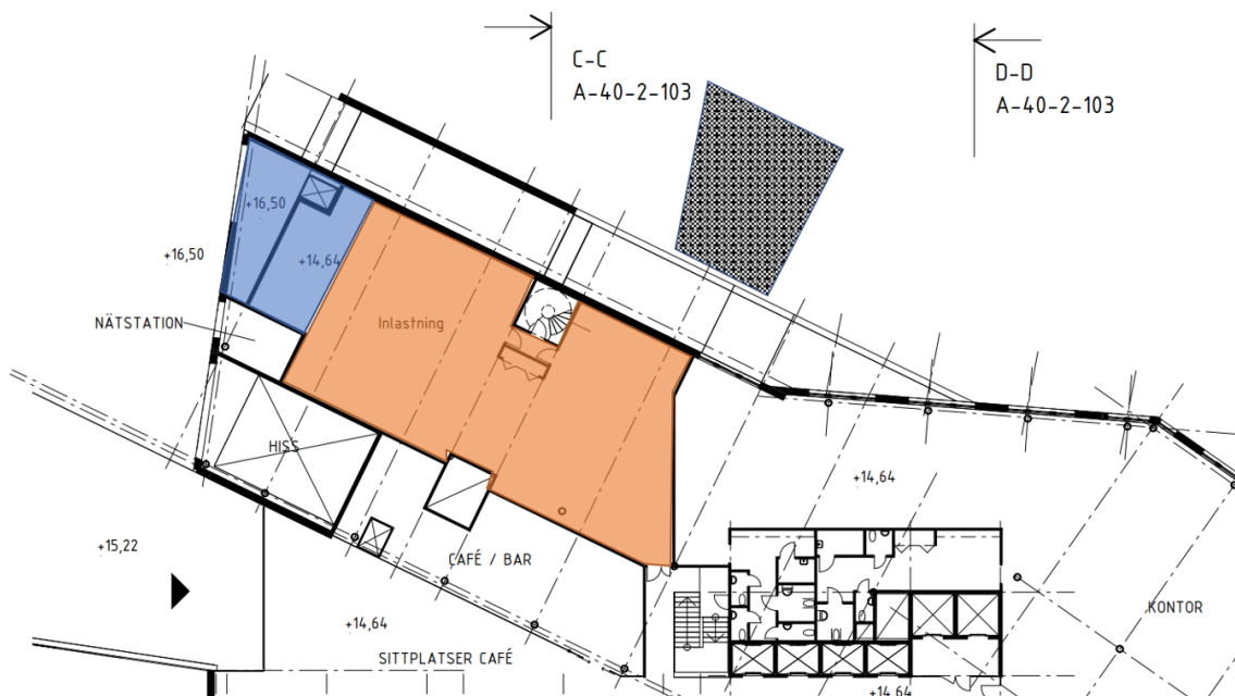
Figur 6 Blå markering visar utrymme för placering av lyftbord och orange markering visar utrymme för godsmottag
