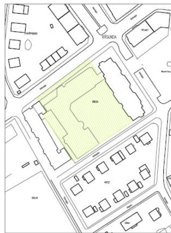
MELLAN ETAPPER Vårdcentral flyttas till färdigställt husdel. Övriga verksamheter evakueras. Befintlig byggnad (en- och tvåvåningsdel) rivs.
